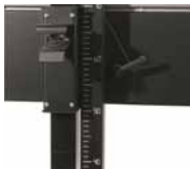
· Deslizamiento vertical con patines de precisión en nylon autolubricado
