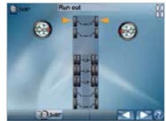
Modalidad 2 sensores. Medición rápida del eje anterior
