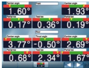
Ajuste de ambos ejes en una única pantalla
