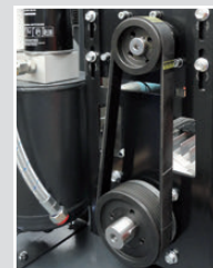
Transmisión La correa poly-V garantiza una larga duración (al menos dos veces superior a las correas trapecoides) y mínimo mantenimiento
