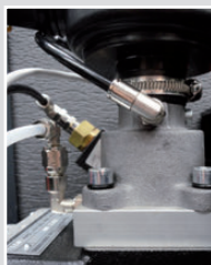
Control de la presión de trabajo con traductor (en versión tronic) El traductor garantiza un funcionamiento preciso y estable. Hace posible modificar la presión del trabajo directamente del control electrónico, sin ninguna intervención mecánica
