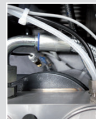
Regulador de aspiración Sistema electro-neumático normalmente abierto. Regula el funcionamiento del compresor garantizando la mínima presión necesaria durante la marcha en vacío para lograr el máximo ahorro energético
