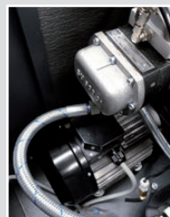
Circuito aire-aceite Todos los latiguillos del circuito aire-aceite están realizados en goma recubierta de malla metálica resistente a las altas temperaturas
