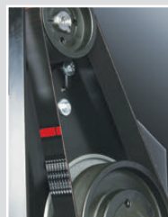
Transmisión La correa Poly-V garantiza una larga duración y mínimo mantenimiento
